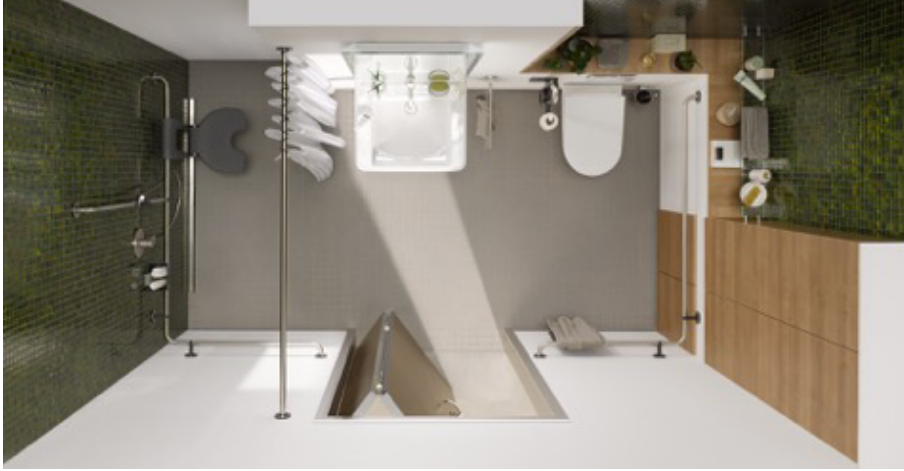
그림 3) 장애인을 위한 공간절약형 문(Raumspartuer, Kueffner) - 입구에서 휠체어를 사용하는 장애인을 위해 실제 문 규격의 1/3 지점에 경첩을 추가적으로 달아 접이식으로 공간을 절약하고 장애우의 접근을 더욱 용이하게 하여 사용의 편리를 제공한다.
