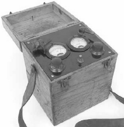
그림 1. Oliver W. Johnson의 의하여 발명된 촉매 연소가스 센서에 의한 첫 번째 연소가스 측정기
