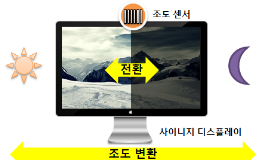
그림 3. 조도 센서를 이용한 에너지 절감 기술
