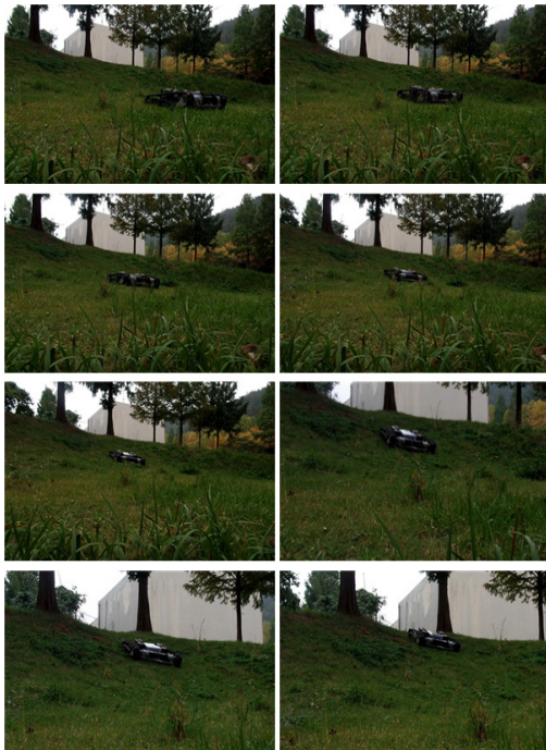
그림 8. 궤도차량로봇의 등판 실험 Fig. 8. Climbing Test of Tracked Vehicular Robot
