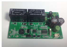
(b) 미터 스위치 (b) Meter Switch
