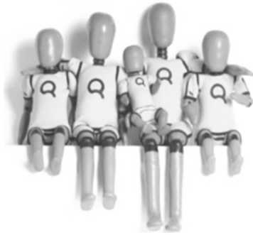
Fig. 2 Q-series of child dummies (left to right Q1.5, Q6, Q0, Q10 and Q3)
