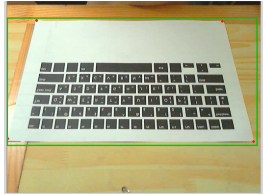
그림 5. 종이 키보드 영역 검출 Fig. 5. Detection of the Area of Paper Keyboard
