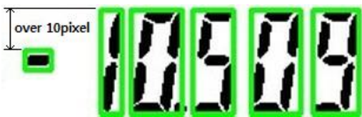
그림 7. 마이너스 측정값 블롭 레이블링 Fig. 7. Negative measured value blob-labeling.
