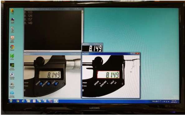
그림 8. GUI기반 측정값 인식 모니터링 시스템 화면 Fig. 8. Window of GUI-based monitoring system for measured value recognition.
