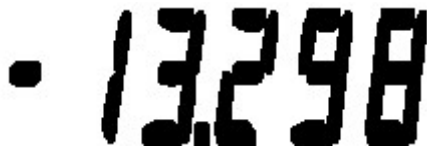
그림 4. 침식과 팽창을 수행한 디지털 숫자 Fig. 4. Performing erosion and dilation digital numbers.
