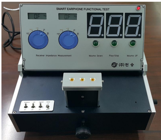
그림 11. 이어폰 기능검사 장치 Fig. 11. Earphone functional test device.
