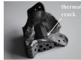
<그림 6> 지지대 설계에 따른 열충격 크랙 발생 예 [10]
