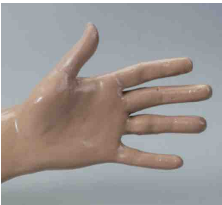
[그림 2] 손 부위 인체 치수 직/간접 측정용 시물레이터 [Fig. 2] Simulated subject for the comparison between direct/indirect measurements for hand anthropometry
