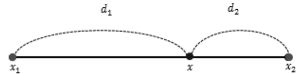
그림 8. 선형 보간법의 일반화 [10] Fig. 8. Generalization of linear Interpolation.
