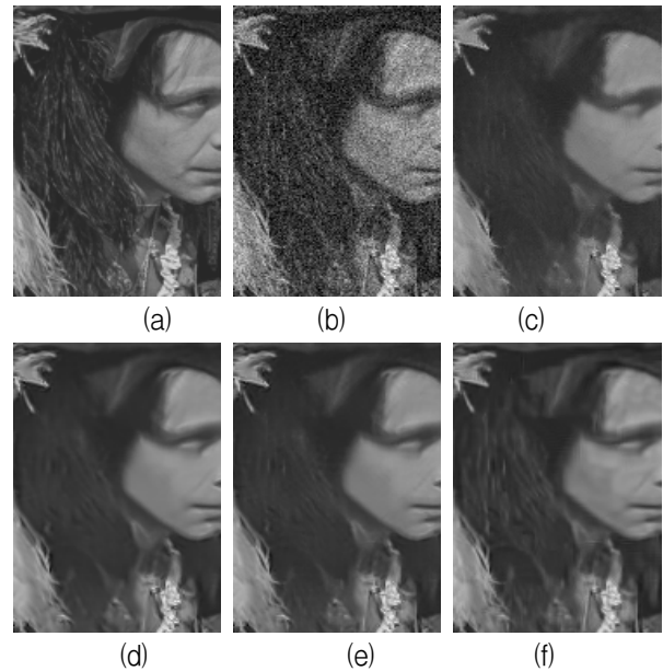
그림 8. 잡음 제거 성능 비교 (Man 영상) (a) 원 영상 (b) 잡음이 첨가된 영상 ( \sigma : 20) (c) 잡음이 제거된 영상 (화소) (d) 잡음이 제거된 영상 (DCT4) (e) 잡음이 제거된 영상 (LiftLT2) (f) 잡음이 제거된 영상 (BM3D)
