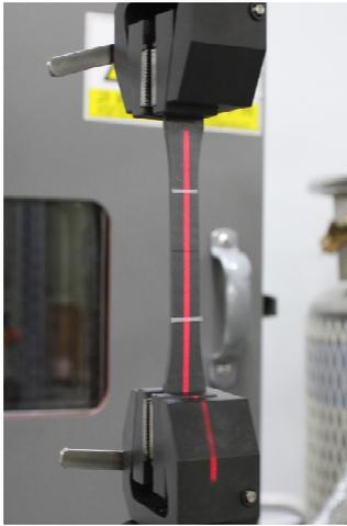
Fig. 3 Tensile test.
