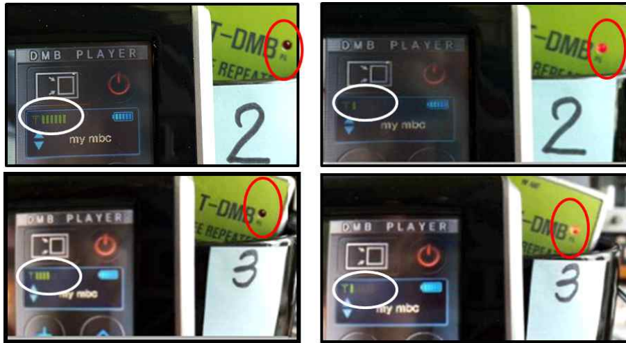
그림 6. 송수신 안테나 동일위치 시 갭 필러와 수신기 동작상태 Fig 6. State of the DMB Receiver at Gap Filler ON/OFF when Tx & Rx Antenna is same position
