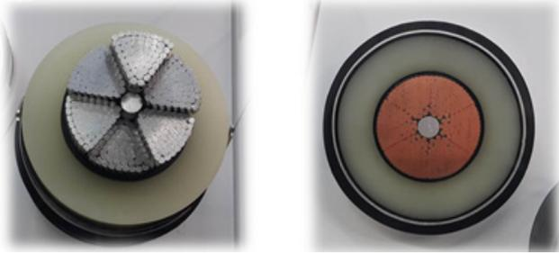
그림 6 AL/Cu 太도체 케이블 ( 3,500 mm<sup>2</sup> )
