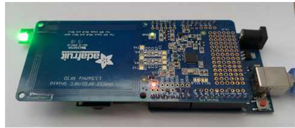
그림 1. 아두이노를 이용한 NFC Read/Write 장치
