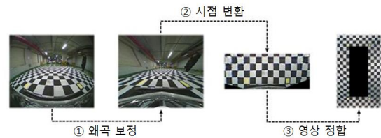
Fig. 2. AVM system process flow 그림 2. AVM 시스템 동작 흐름도
