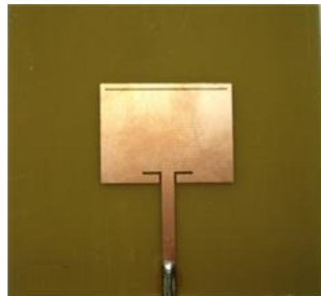
그림 5. 제작된 이중 대역 안테나 사진 Fig. 5. Photo of the fabricated dual band antenna.
