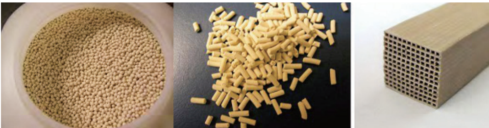
[그림 4] 다양한 형태의 열저장 용 제올라이트(좌로부터 환형, 펠렛 및 채널 성형 블록 형) 4
