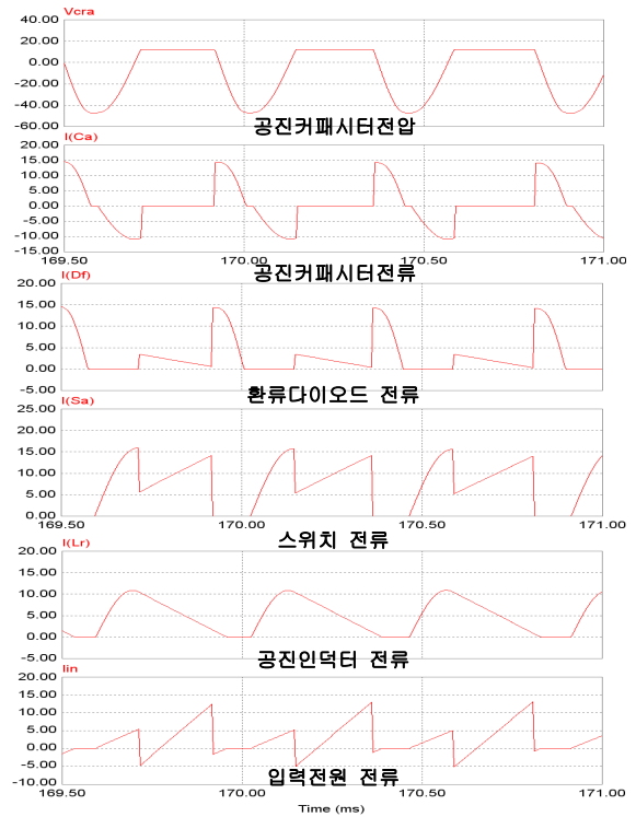
그림 16 적용한 공진형 C-dump 컨버터의 각 부 파형 Fig. 16 Waveforms of each device part
