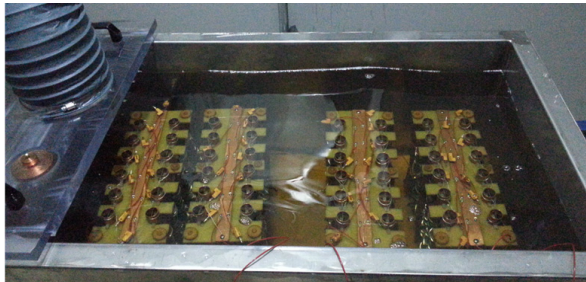
그림 2 가속열화 챔버 및 장착된 시편 Fig. 2 Acceleration chamber with installed specimens
