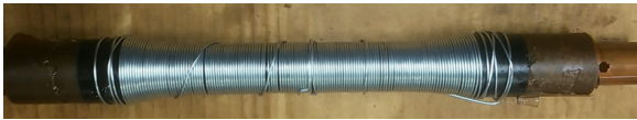
그림 1 케이블 구조의 유침절연지 시편 Fig. 1 Specimen of oil/paper insulation with cable structure
