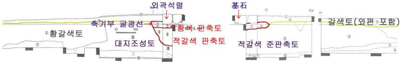
그림 7. 정림사 오층석탑 동·서면 하부 판축토 및 주변 토층(조원창, 2010, 129쪽)
