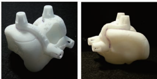
<그림 5> 대퇴골의 3D 프린터로 출력한 환자 맞춤형 수술 도구 가이드 [14]
