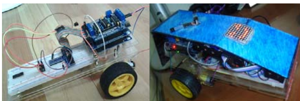
[그림 6] 조립된 자동차(좌)와 감정 표현 장치(우)
