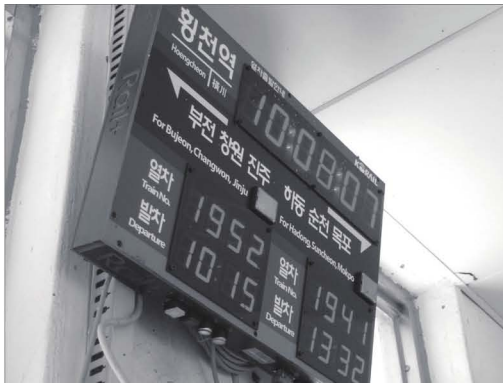
[그림 10] 레일플러스 철도동호회에서 자체 제작, 설치한 LED방식 열차출발안내 전광판
