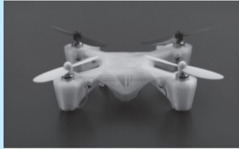
그림 4 입체전자회로기술이 구현된 최초의 상업용 3D프린터인 Voxel 8과 이를 이용하여 제작된 쿼드콥터
