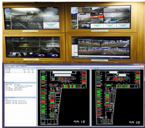
그림 8. 테스트 중인 국내 국제공항 내의 주차유도 시스템 (a) 영상 모니터링 소프트웨어, (b) 주차공간 관리 소프트웨어
