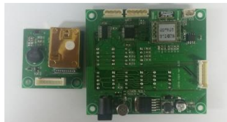
그림 6. 가스센서보드 구현 Fig. 6 Realization of Gas Detector
