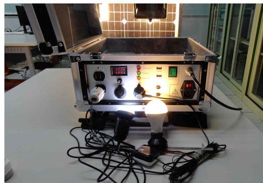
<그림 8> LED 가로등용 전구 DC 24V AC 110V 실험
