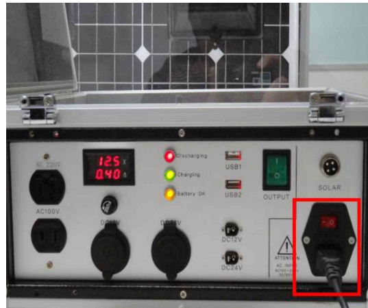
<그림 5> 태양광과 상용전원을 이용한 ESS 충전실형
