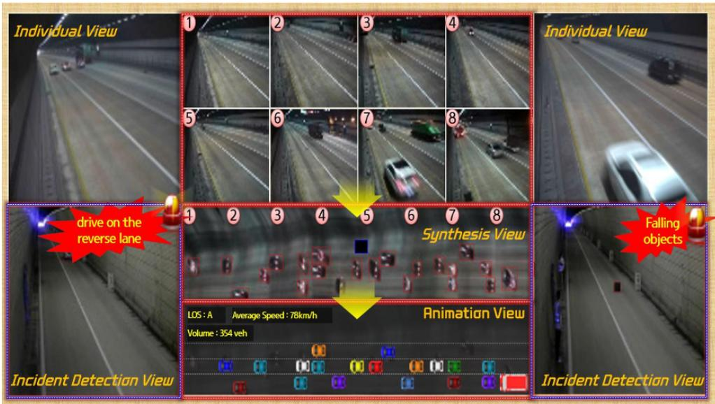
그림 9. 영상정합 기술을 활용한 터널관리시스템 상황판의 콘텐츠 구성(안)
