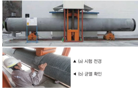
사진 3. 균열 및 파괴 휨모멘트(KS F 4306) 시험
