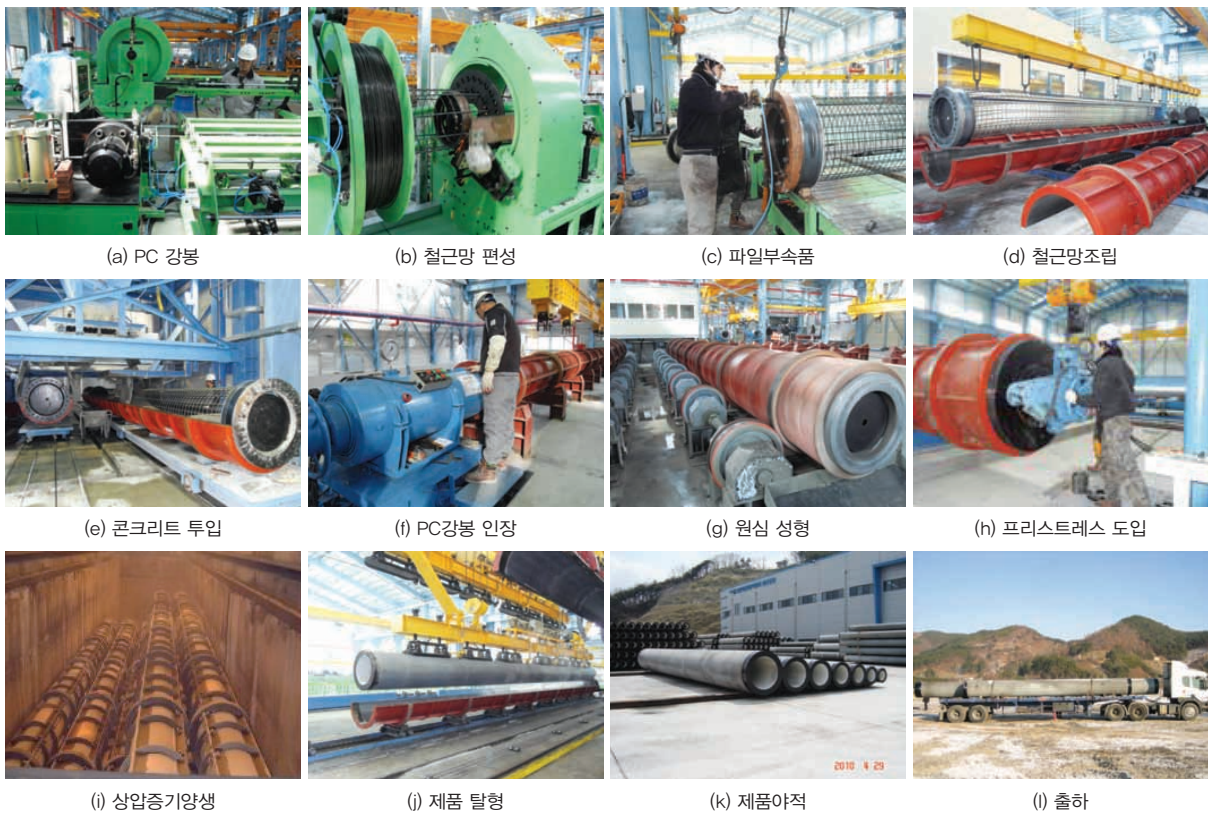
사진 1. PHC 파일 제조 공정
