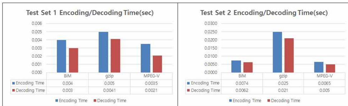
그림 7. 이진화 방법별 인코딩/디코딩 처리시간 비교 Fig. 7. Processing time comparison of en/decoding a XML document per binarization method
