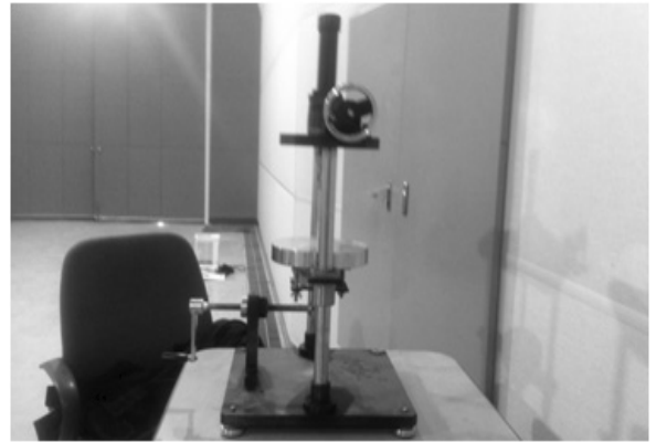
〈그림 10〉 새로운 디스크 커터 마모 시험장치 (NAT, New abrasion tester)
