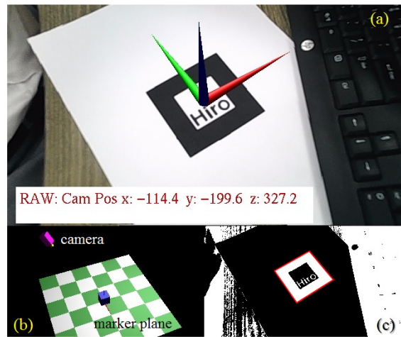
그림 1. ARToolkit을 이용한 마커 기반 증강현실 구현. (a) 입력 영상에 가상 정보 삽입 결과, (b) 마커를 기준으로 카메라의 상대적인 포즈를 표시한 결과, (c) 입력 영상 이진화 및 사각 영역 검출 결과
