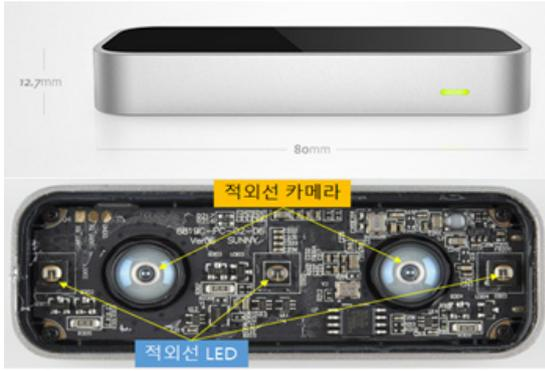
그림 3. 림모션 외형 및 내부 구성
