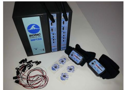
그림 3. 근전도 측정 기기
