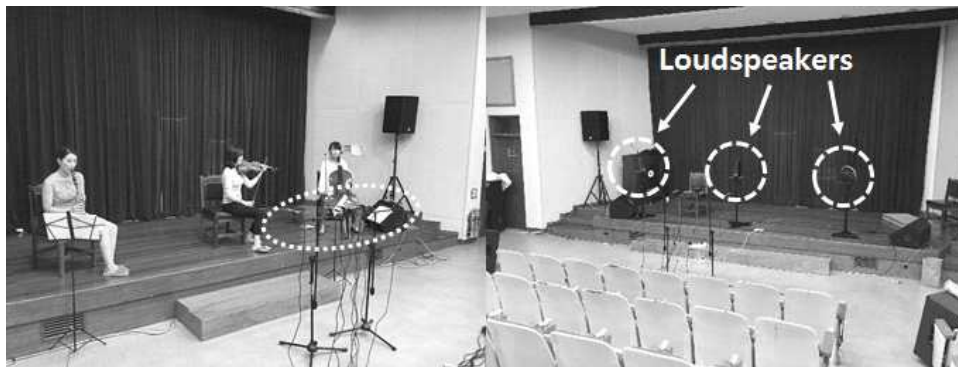
그림 7. 성능 평가를 위한 비균등 선형 마이크로폰 어레이를 활용한 실제 녹음 환경 Fig. 7. Real recording environment using a non-uniform linear microphone array for the performance evaluation
