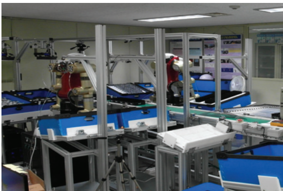
그림 8. 실 구현된 두 대 양팔로봇을 이용한 생산라인. Fig. 8. Physical manufacturing environment with two dual-arm robots.
