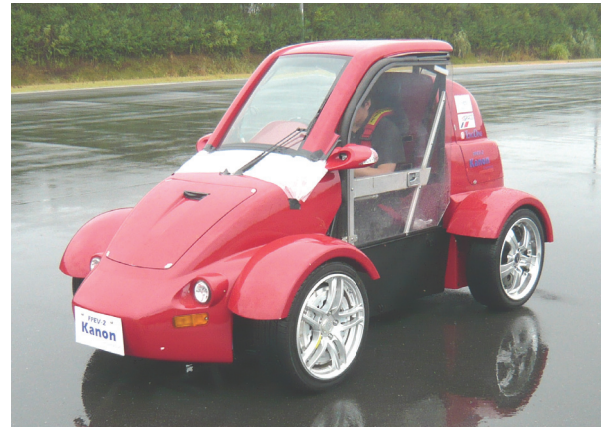
그림 4. 실험용 인 휠 모터 전기자동차[4].
