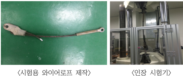
그림 8 와이어로프 인장하중 시험 Fig. 8 Tensile load test of wire rope
