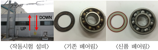
그림 5 작동시험 설비 및 활차용 베어링
