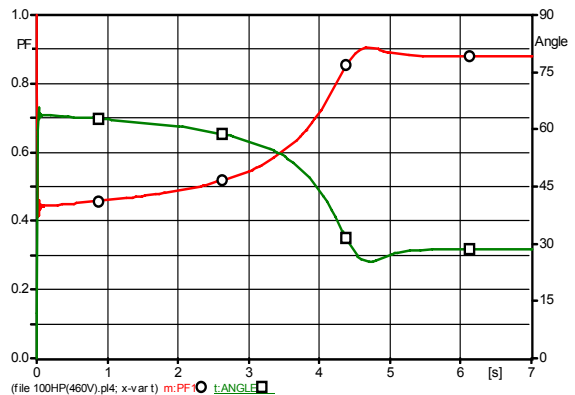
그림 3 역률과 점화각 Fig. 3 Power factor and firing angle
