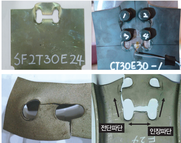
그림 4. 볼트접합부의 전형적인 블록전단파단 형태
