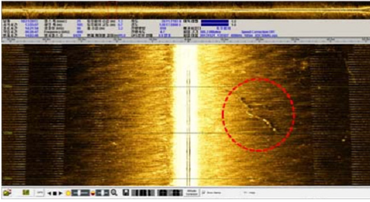
그림 2. 사이드스캔소나로 탐지된 침적쓰레기(로프) Fig. 2 SMD detected by SSS (rope)
