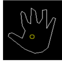
(그림 5) 손 중심점과 윤곽선 검출 (Figure 5) Detection of the center point and outline of the hand
