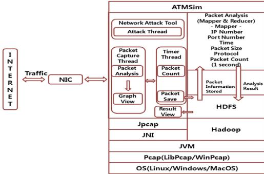
(그림 3) ATMSim의 상세 시스템 구조
