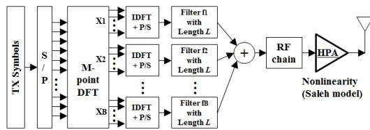
그림 7. DFT-s-UFMC 송신기의 구성도
