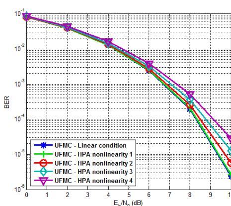
그림 16. 비선형 조건에 대한 UFMC 시스템의 BER 성능
