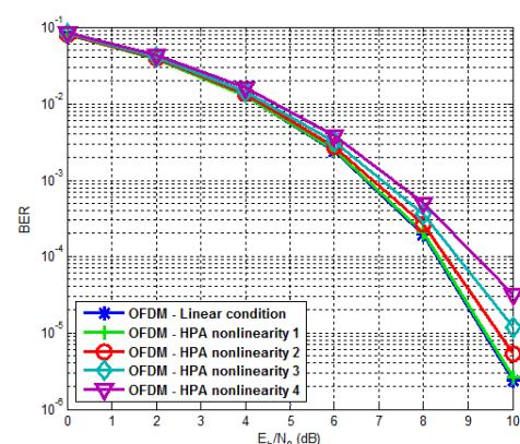
그림 14. 비선형 조건에 대한 OFDM 시스템의 BER 성능
