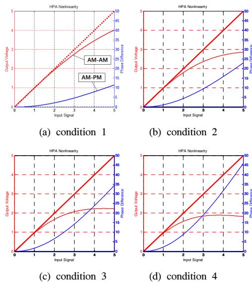
그림 13. HPA 비선형 조건에 대한 AM-AM 및 AM-PM 특성
