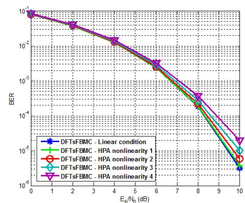
그림 19. 비선형 조건에 대한 DFT-s-FBMC 시스템의 BER 성능
