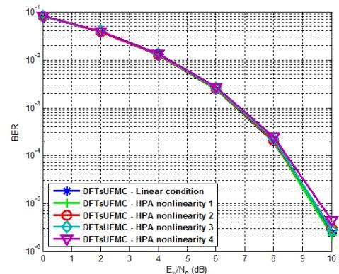
그림 17. 비선형 조건에 대한 DFT-s-UFMC 시스템의 BER 성능
