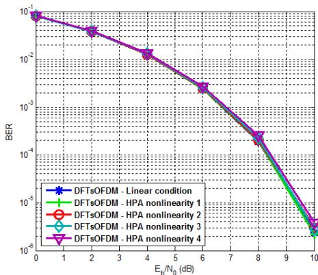
그림 15. 비선형 조건에 대한 DFT-s-OFDM 시스템의 BER 성능
