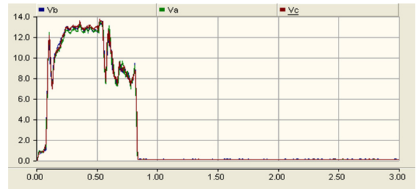
그림 17 디젤 발전기 비연계 시 전압 특성 분석 Fig. 17 Voltage characteristic by using only CVCF ESS
