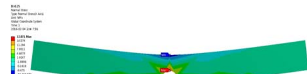
(d) H/h=1.91 , r/h=0.45 , P=44.45N , \sigma_{max}=17.871MPa
