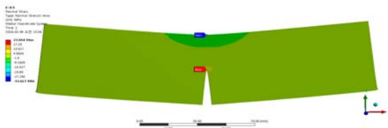
(d) a/H=0.5 , a=0.025m , P=88.9N , K_I=0.623 MPa \sqrt{m}
