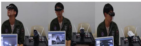
그림 11. HMD를 활용한 팬틸트 카메라 제어 Fig. 11. Pan-tilt camera control using HMD
